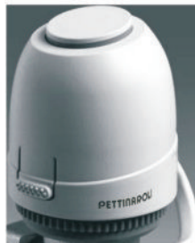
电热执行器 常开/常闭 与分水器连接,由室内温控器发出控制信号。
